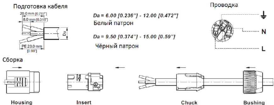
Рисунок 10 – Соединение разъёма входа питающего напряжения с кабелем
